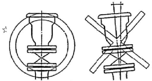
☆充水が完了したら、補修弁は必ず全開状態に戻してください。
