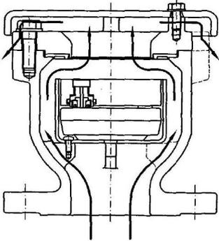
管路に充水するとき、管路内の空気を大空気孔から急速に多量排気を行います。
