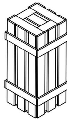
すかし箱の脚の外側を2本のスリングベルトで吊ってください。
