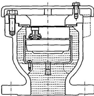
管路が満水状態になると、浮力によって遊動弁体とフロート弁体が上昇し、空気孔を閉じ、水の流出を防ぎます。
