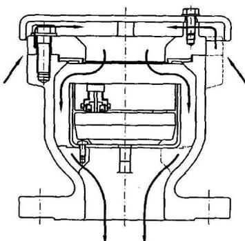
管路の水を排水するとき、遊動弁体とフロート弁体が降下し、多量吸気を急速に行います。
