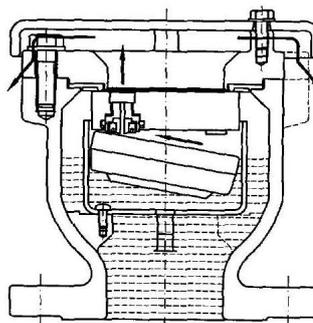
管路内の空気が空気弁内に溜まると、自重によってフロート弁体が降下し、小空気孔により自動的に排気します。
