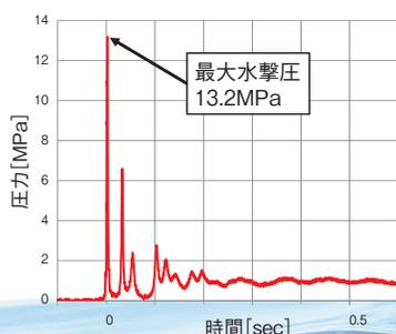
急速空気弁にて発生した水撃圧
