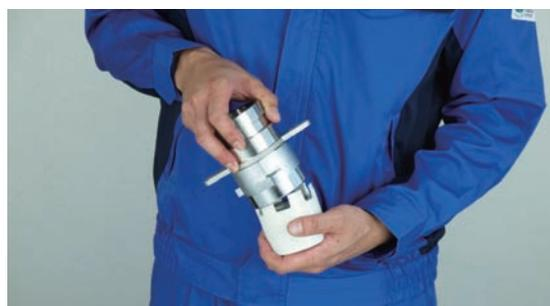
⑥ 町野式口金とフロート弁体案内を引き離し、フロート弁体案内の中にある遊動弁体、フロート弁体を取り出してください。
