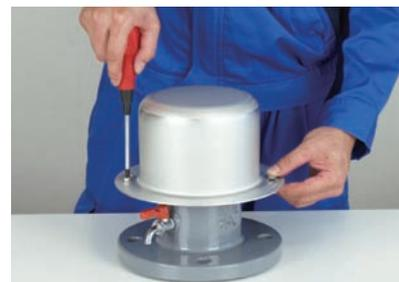
⑤ カバーを取り付け、右(時計回り)に回した後、ドライバーなどで2箇所六角ねじをしっかりと締め付けてください。
