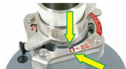
③ フロート弁体案内をセットした町野式口金を本体に押し込み、右(時計回り)に止まるまで回してください(ロックピンのつまみが一度飛び出し「カチッ」と音がします)。
