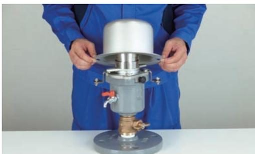
③ カバーを**少し左(反時計回り)**に回して上へ取り外してください。
