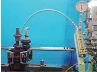
製作から約40年経過した消火栓を用意し、弁箱とパッキン箱接続部の六角ボルト・ナットを緩めた状態でカロックを取り付け、下記条件で試験圧力を加え消火栓及び補強金具に異常がないか確認する。カロックの標準締め付けトルクは40N・m
