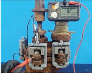
老朽化した消火栓にステンレス製の金具を接合した場合、異種金属接触腐食が生じる可能性があります。
