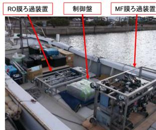
図7. 分割した装置を、漁船に積み込み輸送している状況
